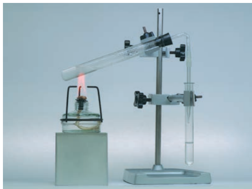
Мал. 21.2. Добування етанової кислоти в лабораторії
