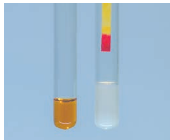
Мал. 17.1. Бромна вода (ліворуч) та після додавання фенолу (праворуч)
