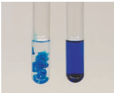
Мал. 16.3. Свіжоосаджений купрум(II) гідроксид (ліворуч) та після додавання гліцеролу (праворуч)
