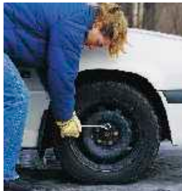
Fig 10. Det är lättare att lossa en mutter med det längre verktyget.
