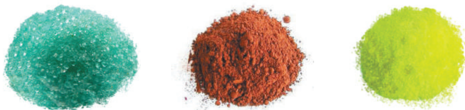
Мал. 35.1. Солі: a — ферум(II) сульфат (залізний купорос) \text{FeSO}_4 ; б — ферум(III) хлорид \text{FeCl}_3 ; в — калій хромат \text{K}_2\text{CrO}_4
