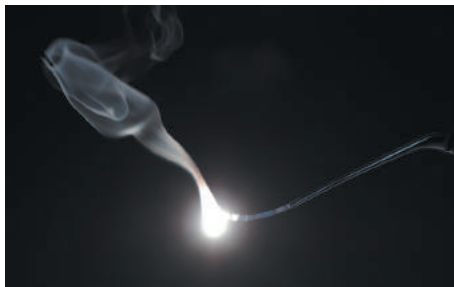
Мал. 38.1. Під час горіння магнієвої стрічки утворюється магній оксид і велика кількість світла
