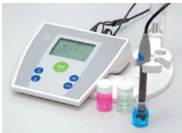
Мал. 41.1. рН-метр визначає наявність кислот та основ у розчинах
